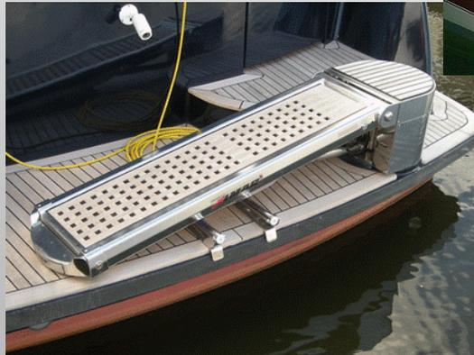
Drehbare Teleskopgangway mit 6 Kanal Funkfernbedienung, freitragend
