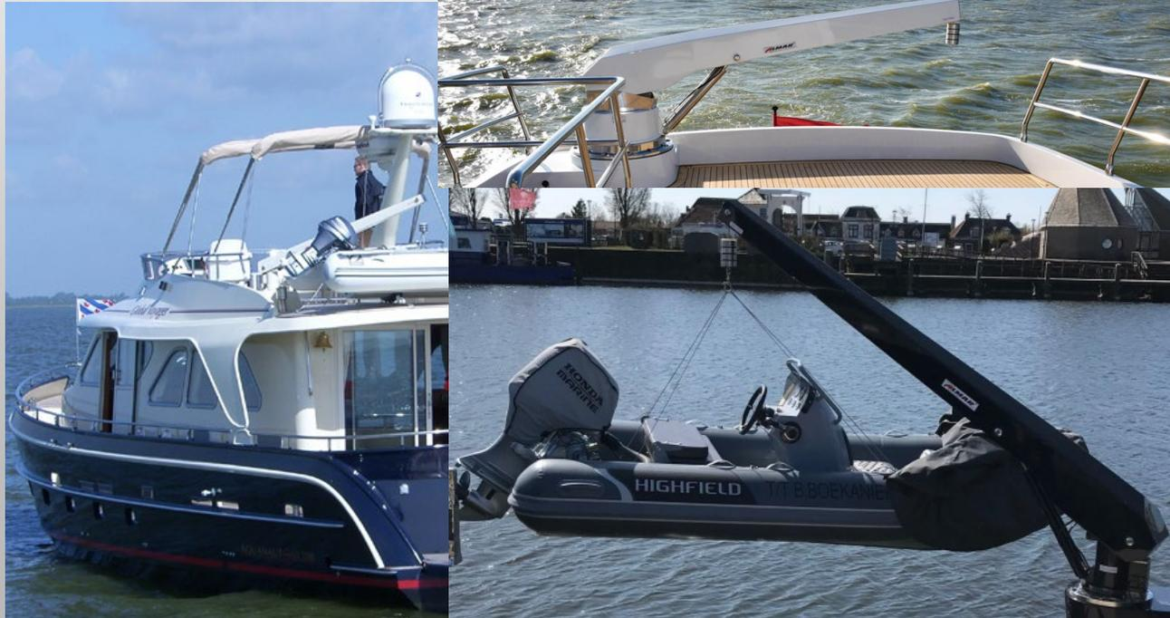
Hydraulischer Kran mit 6 Kanal Fernbedienung
