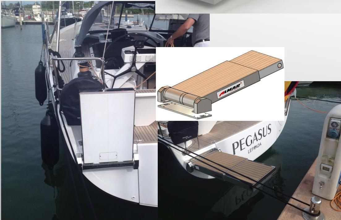
Drehbare Teleskopgangway mit 4 Kanal Funkfernbedienung, freitragend
